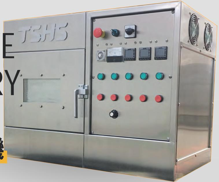
總興公司與食品工業研究所一起合作研發「微波混合能源應用」新技術，目前已成功被台灣部分產業採用。微波加熱是透過水份子高速度震盪，互相摩擦而轉換成熱能，加速產品的加熱速度，達成水分蒸發、脫水及乾燥的效果。一般熱風乾燥，熱傳導方式是由外往內傳遞，而微波能使產品中水分子同時摩擦震盪，內外同時進行加熱，提高物體加熱速度。因此混合微波功能，相較傳統熱風乾燥，乾燥速度可縮短大約一半的時間。
